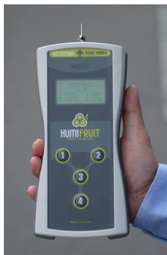
Appareil portable qui mesure instantanément le taux d'humidité des fruits séchés. ©Imiwave
