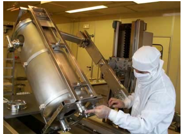
© IPN - Conditionnement d'une cavité accélératrice en salle blanche
