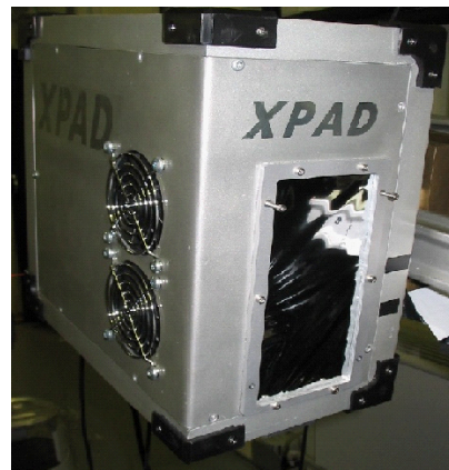
© Photographie d'un détecteur imXPAD de 540 000 pixels (12 x 7,5cm 2 ).
