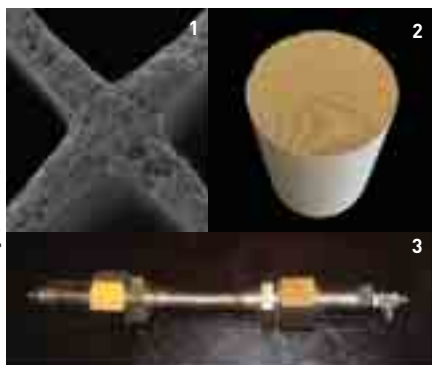
Aperçu d'un procédé catalytique de production d'hydrogène sur réacteur structuré, de l'échelle nanoscopique (croisillon de monolithe en nid d'abeille revêtu de sa couche catalytique - figure 1), au réacteur de laboratoire (équivalent à une puissance de 1 kW - figure 3), en passant par la structure générale du monolithe (figure 2).
