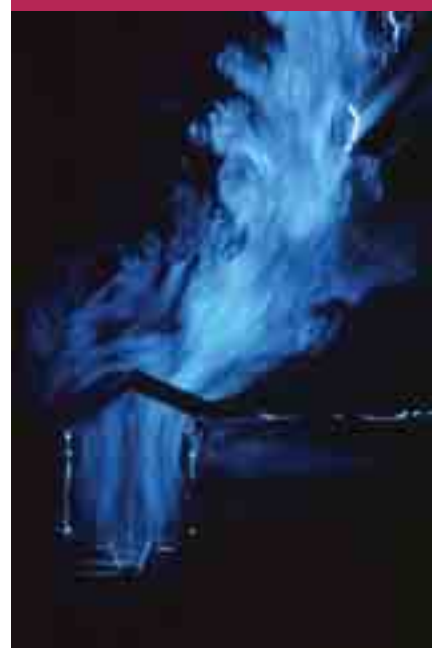
La visualisation des mouvements d'air internes aux bâtiments (au voisinage d'une bouche d'air sur la photo) contribue à la compréhension des turbulences et participe à la maîtrise du transfert de chaleur.
