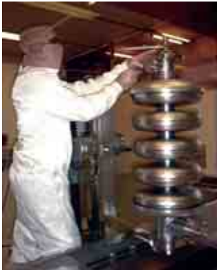
© I.P.N. Orsay. Composant d'un accélérateur moderne : cavité supraconductrice en niobium. L'importance de la propreté de surface explique le travail en salle blanche.
