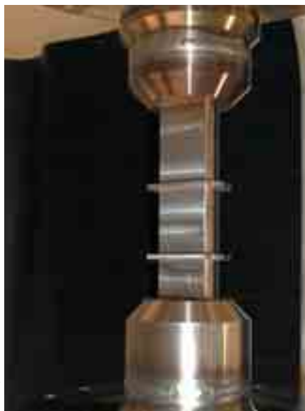
Tube d'échantillon en T 91 de Lisor. Cet appareil, conçu pour l'étude de différents matériaux de structure sous irradiation en contact avec des métaux liquides et sous contrainte mécanique, est construit dans le cadre du groupement de recherche Gédéon (Gestion des déchets par des options nouvelles du programme PACE).
