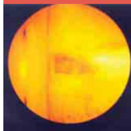
Étude d'un régime de combustion du gaz naturel avec forte re-circulation des gaz brûlés.
