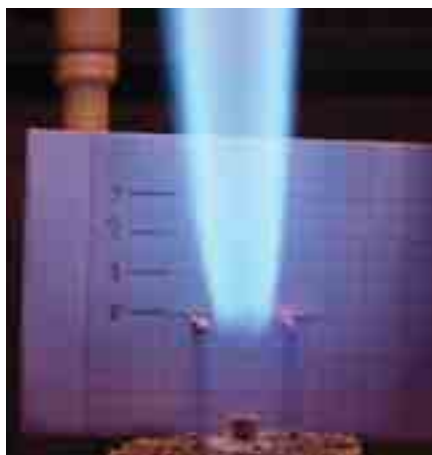
© CORIA. Stabilisation d'une flamme par plasma.
