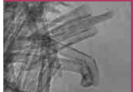
Image par microscopie électronique à très haute résolution de nanotubes d'oxyde de titane.
