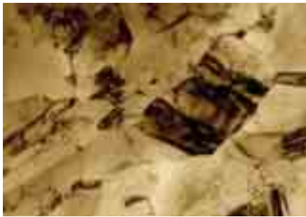
Grains de cuivre nanostructurés mesurant environ 100 nanomètres observés en microscopie électronique à transmission.
