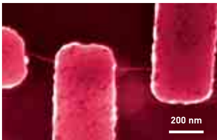
Transistor à base d'un nanotube de carbone auto-assemblé et connecté électriquement pendant sa synthèse.
