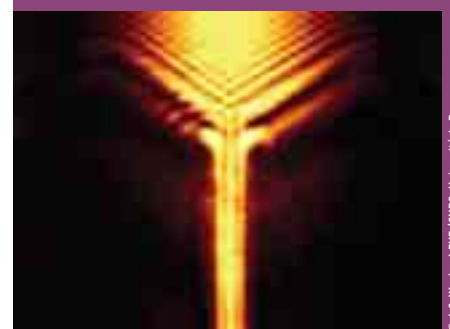
Fonctionnalité optique d'un ruban en or de 40 nm d'épaisseur.
