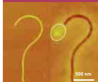
À gauche : image de microscopie à force atomique d'un nanotube de carbone. À droite : image de microscopie à force électrostatique après une expérience d'injection de charges. On peut constater l'émission de charges à l'extrémité du nanotube.
