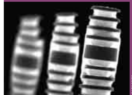
Microcavités à semiconducteur. L'alternance de deux matériaux dans la même direction verticale forme le miroir et confine la lumière dans le « corps » de la cavité située au centre.
