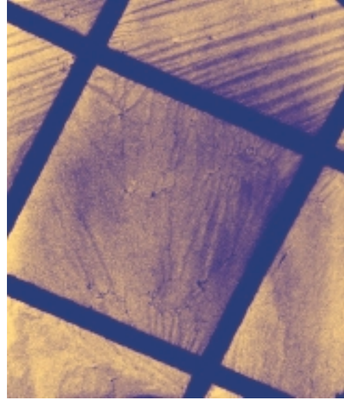
Figure - Photographie d'une feuille d'or de 23 nm d'épaisseur auto-supportée sur une grille métallique de pas millimétrique.
