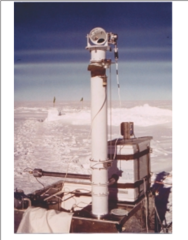
Figure 1 - Premier instrument astronomique à avoir fonctionné avec succès au Pôle Sud géographique en Décembre 1979, cet héliosismomètre, qui ne portait pas encore ce nom, alimenté par un petit télescope ayant l'originalité d'être à la fois équatorial et azimutal, a pour la première fois permis l'identification de fréquences individuelles des modes propres du Soleil. Équipé d'une cellule à résonance optique de sodium, il est l'ancêtre des futurs instruments du réseau IRIS et de l'instrument spatial GOLF.
