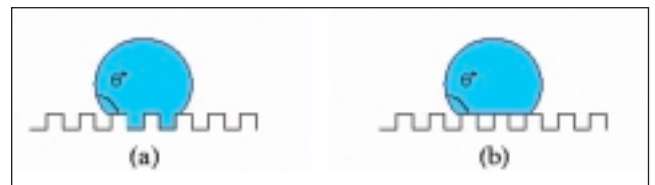
Figure 2 - Les deux états super-hydrophobes : dans l'état de Wenzel, le liquide épouse la surface solide (a) ; dans l'état de Cassie, il repose sur le sommet de ses aspérités (b).
