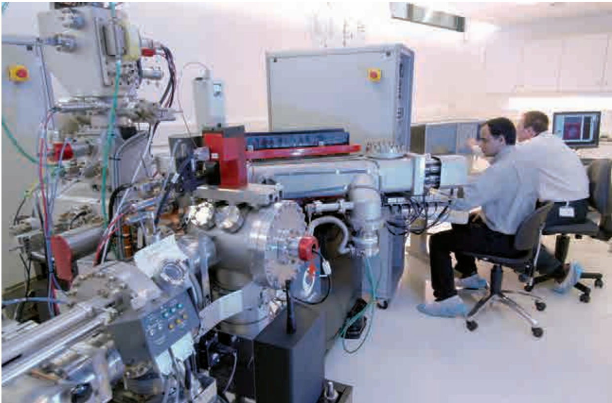
Fig 2.: Avec la sonde ionique NanoSims, il est possible d'établir une cartographie chimique et isotopique de ces compositions des premières couches atomiques à la surface d'un échantillon, avec une résolution spatiale de 0,05 micromètres. © Hubert RAGUET/MNHN/INSU/CNRS Photothèque.
