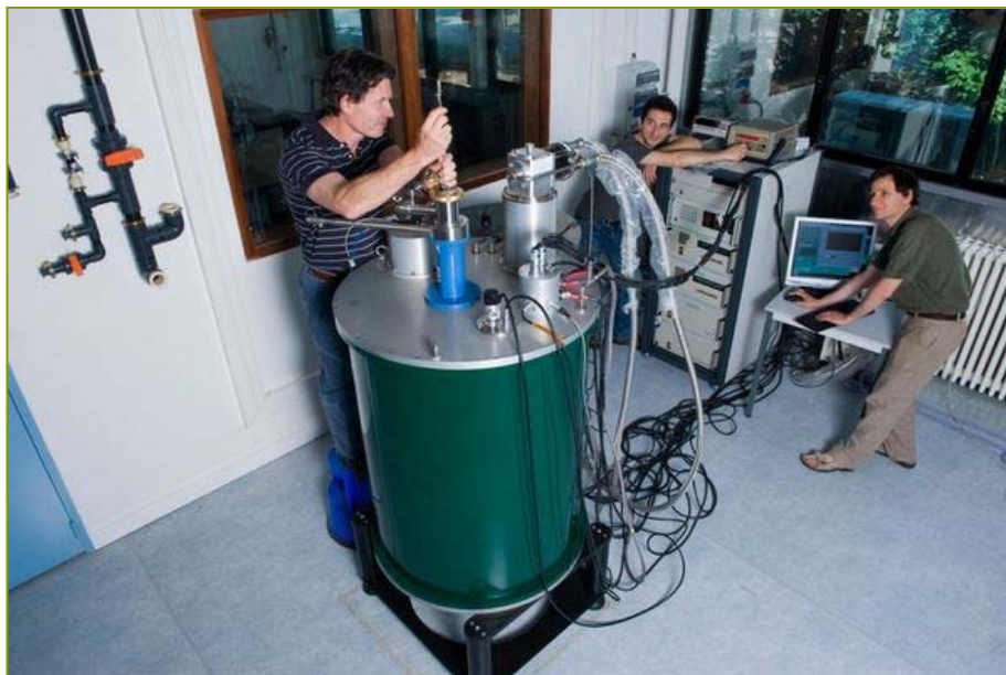
Le cylindre vert est une bobine produisant un champ magnétique très élevé pour réaliser des mesures de résonance magnétique nucléaire (RMN). ©RAJAU Benoît
