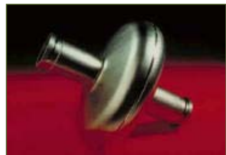
Cavité accélératrice supraconductrice en nobium. ©CEA/Irfu
