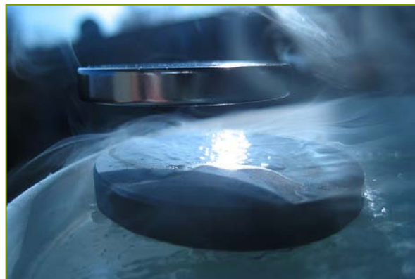
Effet de lévitation magnétique dans un matériau supraconducteur à haute température critique. ©J. Bobroff LPS/CNRS
