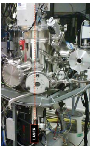
Bâti de pulvérisation magnétron et schéma de principe du dispositif de mesure optique kSA MOS de la courbure d'un bilame film/substrat.
