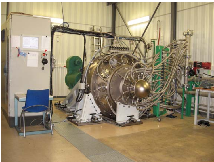
Le banc d'essais d'étanchéité « BALAFRE », Banc palier à air: comportement statique et dynamique des paliers aérodynamiques (vitesse de rotation maximale 6 krpm).
