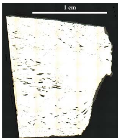
Section polie non attaquée de l'extrémité d'un tenon prélevé à la cathédrale de Chartres. En clair, la matrice métallique; en sombre, les inclusions de scorie.
