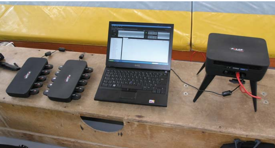
L'appareillage de télémétrie cardiaque permettant de contrôler que les participants travaillaient bien à la bonne intensité d'exercice au cours des séances et d'enregistrer la variabilité de la fréquence cardiaque.
