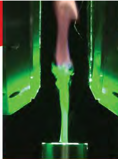
Stabilisation de flamme par champs magnétiques © ICARE
