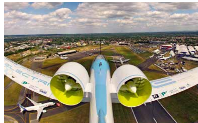
E-fan, avion électrique équipé de voilures composites démontables.
