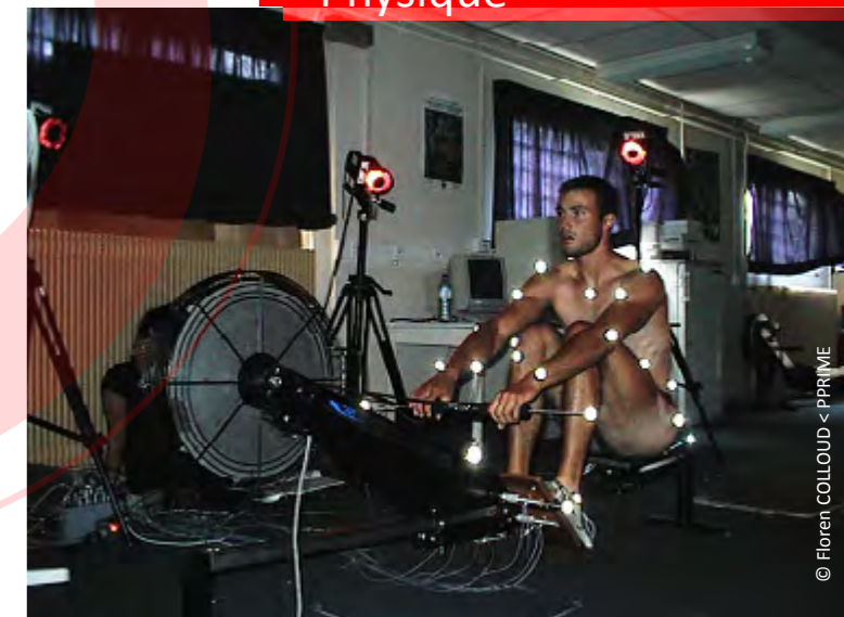
Frédéric Perrier, sportif de haut niveau en aviron, lors d'une campagne expérimentale sur ergomètre mobile. Ce dispositif expérimental pour l'évaluation en laboratoire du mouvement d'aviron comprend des mesures dynamométriques (capteurs de forces au niveau des deux pieds, de l'assise et des mains) et cinématographiques (système d'analyse du mouvement optoélectronique et marqueurs réfléchissants disposés sur le corps pour évaluer la cinématique articulaire).
