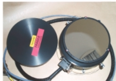
Figure 2 - Les deux miroirs de correction utilisés dans NAOS : en haut le miroir déformable de la société CILAS qui comporte 185 barreaux piézo-électriques (de couleur ocre) poussant ou tirant une lame de Silicium poli de 1 \text{ mm} d'épaisseur ; en bas : le miroir deux axes développé par LESIA.
