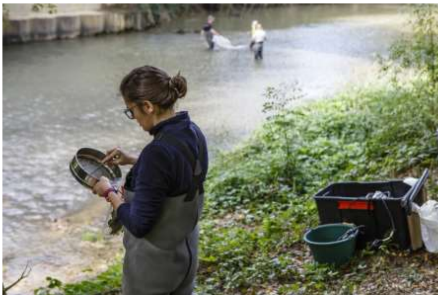
Tamisage des prélèvements récupérés dans les filets Manta de mailles 500 microns mis en place pour collecter des particules en suspension dans l'eau de la Save, en aval de Toulouse, à Grenade, le 16 octobre 2018. Les stations de suivi sont choisies à proximité d'un pont afin de pouvoir effectuer les prélèvements lorsque le cours d'eau n'est pas praticable à pied. © Vincent NGUYEN / PLASTIGAR / CNRS Photothèque
