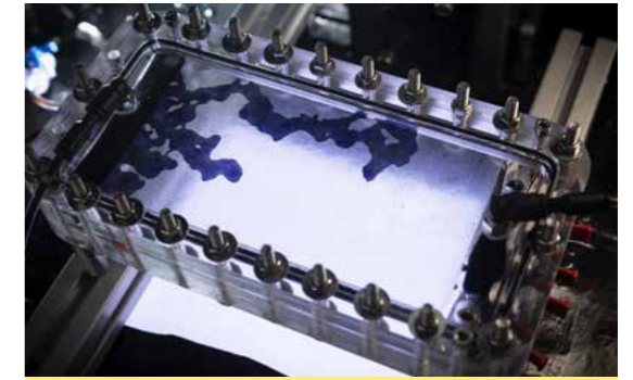
Étude du déplacement d'une phase aqueuse par du CO 2 injecté dans un modèle de fracture géologique.
