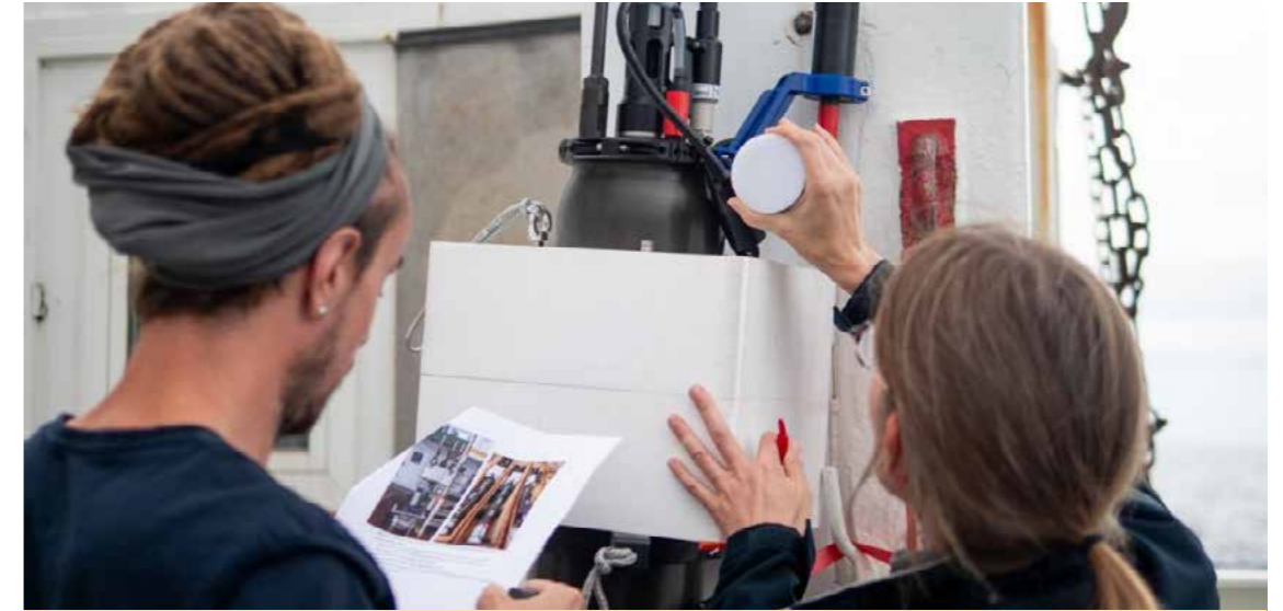
Préparation d'un flotteur-professeur biogéochimique (BGC-Argo) avant son déploiement dans l'océan Atlantique, au large de la province canadienne de Terre-Neuve.
