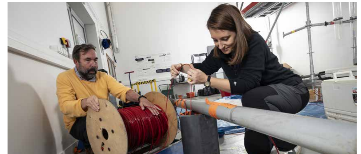
Tests instrumentaux de mesures distribuées de température, pôle Eau souterraine de l'OSERen.
