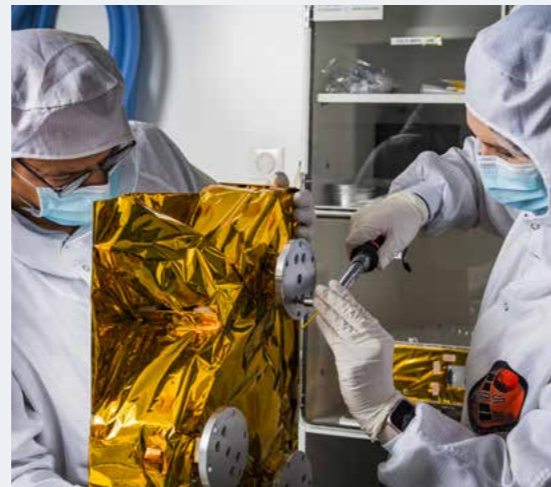
Montage des patins de fixation du boîtier optique « doré », l'Obox, du spectromètre imageur infrarouge MIRS.
