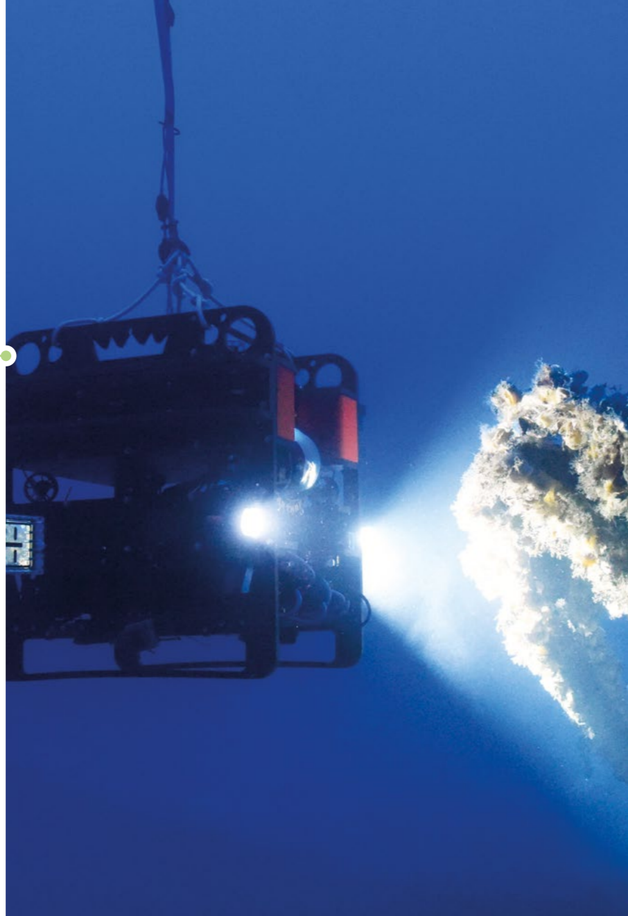
Le robot archéologue Arthur — conçu par des chercheurs du Laboratoire d'informatique, de robotique et de microélectronique de Montpellier (Lirmm) en collaboration avec la Drassm — peut explorer les mers jusqu'à 2 500 mètres de profondeur. © D. Degez / V. Creuze / DRASSM / LIRMM
