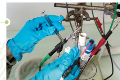
Prélèvement de monoxyde de carbone à l'aide d'une seringue à gaz. © Cyril FRESILLON/LEM/CNRS Images
