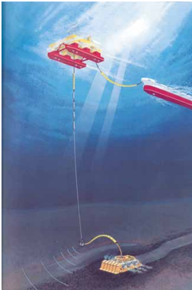
Figure 3 : Vue d'artiste et principe du chantier de ramassage des nodules polymétalliques.
