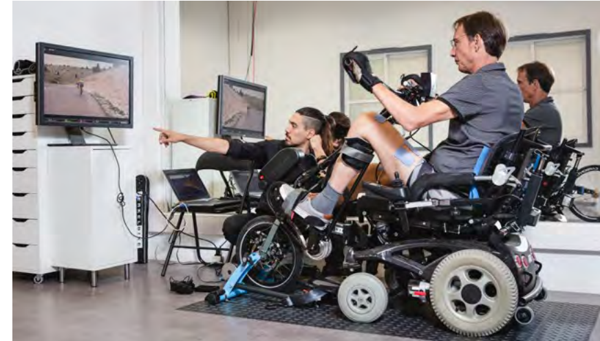
Amine Metani et Vance Bergeron testant le vélo stationnaire à simulation électrique fonctionnelle (SEF) universel permettant de mobiliser les membres inférieurs paralysés. Ce vélo a été conçu et développé par l'équipe de Vance Bergeron dans le cadre de l'association ANTS. Il permet la contraction des muscles plégiques par stimulation électrique.
