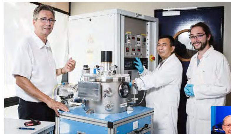
Préparation des échantillons à l'aide d'un évaporateur par Thomas Ebbesen, Yantao Pang et Jérôme Gautier tous deux membres de son équipe à l'ISIS.
