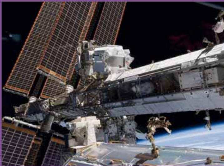
AMS-02 installé sur la poutre S3 de la Station spatiale internationale.
