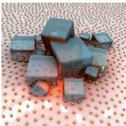
Image de synthèse de microcristaux sur un tapis de nanoparticules d'or agissant comme nanosources de chaleur sous illumination laser.
