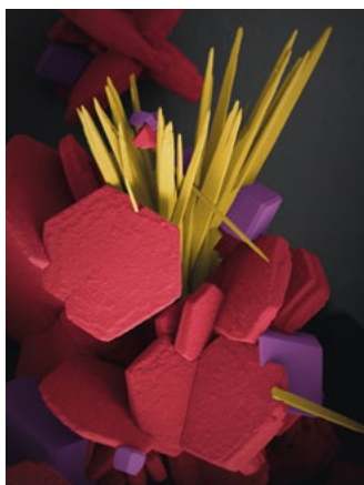
Cristaux de carbonate de calcium ( \text{CaCO}_3 ) de formes cubique, hexagonale et en aiguille, imbriqués les uns dans les autres. Cette image a été réalisée au microscope électronique à balayage avec un grossissement x 3 000. La photo est retraitée et colorisée avec des couleurs artificielles. © Bertrand Rebiere / IGCM / CNRS Photothèque
