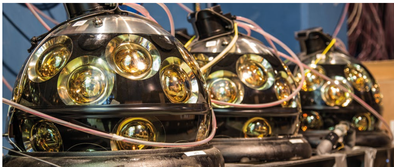
Capteurs de lumière Tcherenkov du télescope à neutrinos KM3NeT/ORCA en cours d'installation en Méditerranée.
