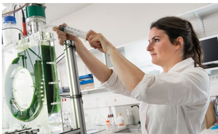
Réacteur torique pilote dans lequel une microalgue de référence est mise en culture. © Jean-Claude MOSCHETTI/GEPEA/CNRS Photothèque
