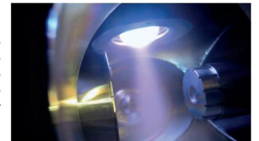
Dépôt de couches minces par pulvérisation plasma magnétron.
