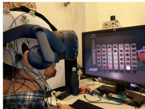
Preuve de concept actuelle, couplant EEG et RV, dans l'utilisation de marqueurs cérébraux de l'attention en temps-réel pour le contrôle d'une interface cerveau-machine (exemple du jeu de puissance 4).
