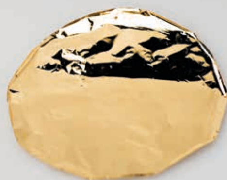
Feuille d'or obtenue par dépôt physique en phase vapeur (PVD en anglais). La start-up Daumet exploite un nouvel alliage d'or et de tungstène, SpinD Gold, issu des recherches de l'Unité mixte de physique CNRS/Thales. © Cyril FRESILLON / Daumet / CNRS Images
