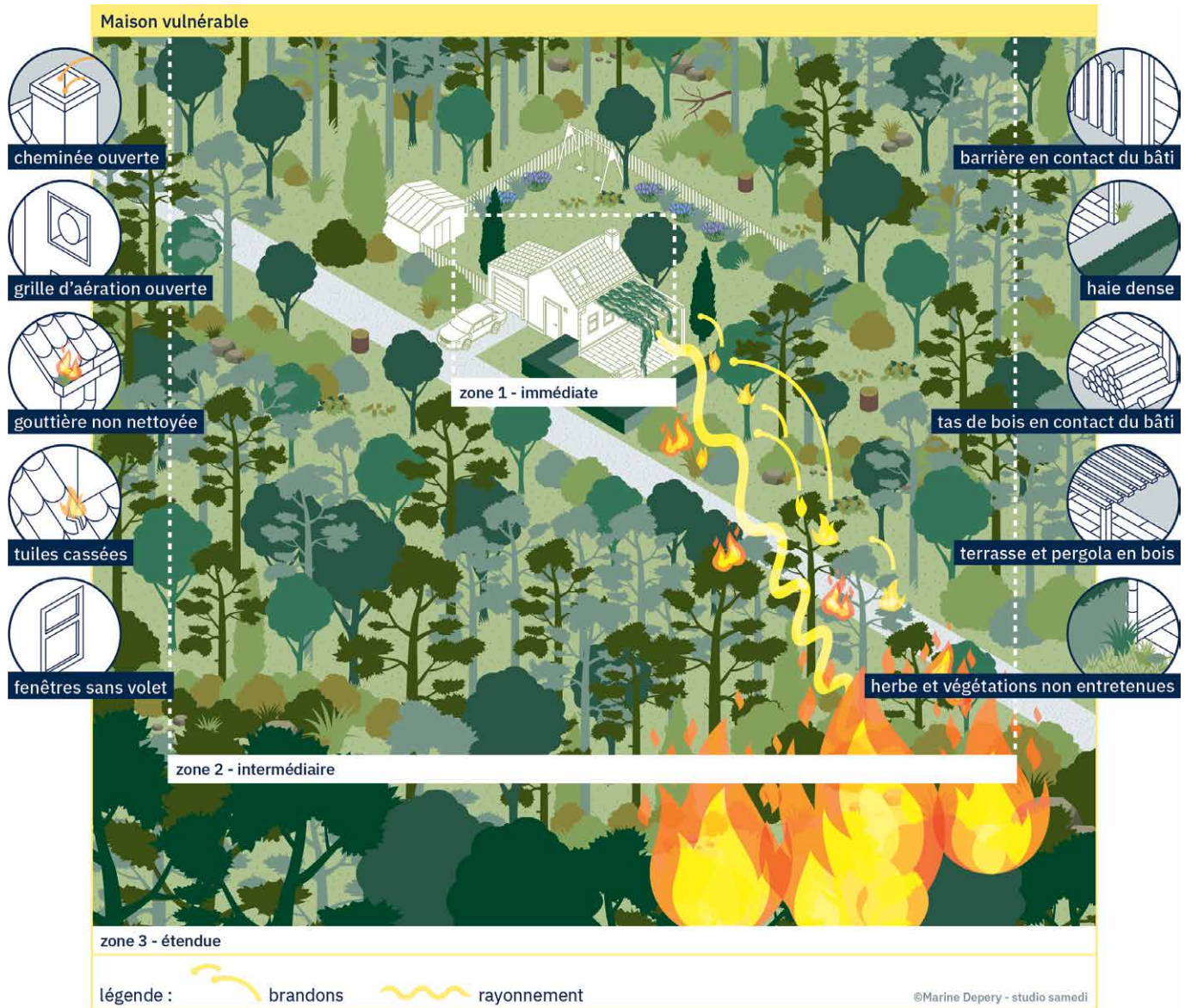
Figure 10 : Maison vulnérable. La vulnérabilité de la maison dépend de son environnement et des méthodes constructives. La présence de végétation qu'elle soit naturelle ou ornementale, ainsi que de matériaux combustibles (clôture, abri, tas de bois...) favorise la propagation du feu à travers les différentes zones situées entre la maison et l'espace naturel (immédiate, intermédiaire et étendue, voir Chap. 6, Prévention).
