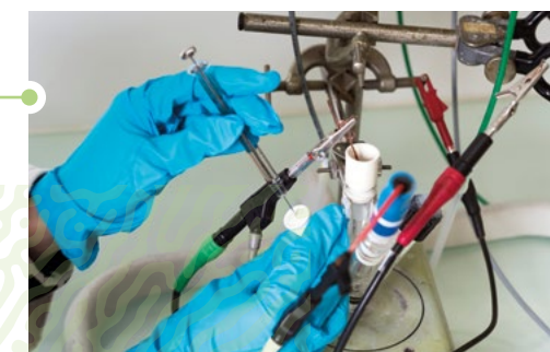
Prélèvement de monoxyde de carbone à l'aide d'une seringue à gaz. © Cyril FRESILLON/LEM/CNRS Images
