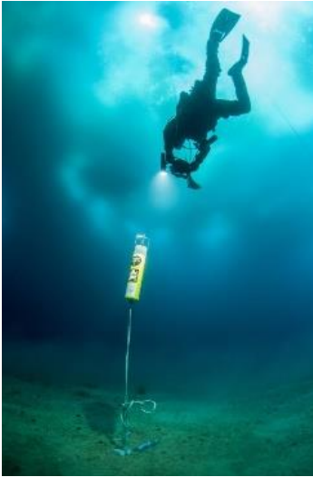
Plongeur venant contrôler et récupérer un hydrophone sous la banquise en Terre Adélie. © Erwan AMICE / LEMAR / CNRS Photothèque
