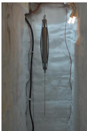
Sonde de température développée à l'Institut des géosciences de l'environnement (OSUG, CNRS/IRD/UGA/Grenoble INP) pour des mesures dans le trou de forage d'Epica à Concordia.
