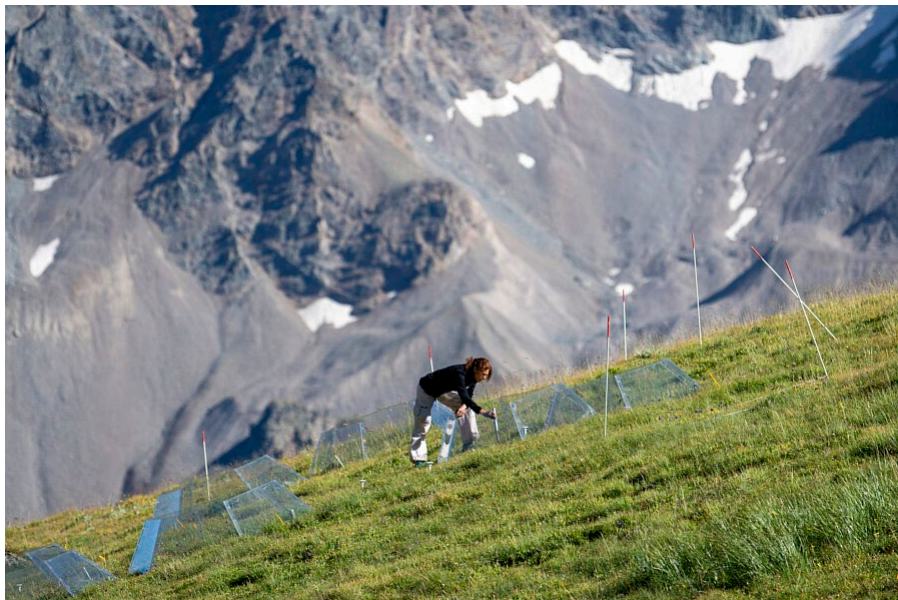
Sandra Lavorel, lauréate de la médaille d'or du CNRS 2023, entourée des dispositifs du projet Warm, qui étudie l'effet du changement climatique sur les pelouses alpines. Installés sur le col du Lautaret, à 2 400 m d'altitude, ils réchauffent l'air de quelques degrés par rapport à l'extérieur pour étudier les conséquences sur l'écosystème (production de la biomasse, température et humidité des sols).
