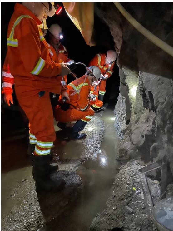
Légende photo : Mesure de gaz à 1000 mètre de profondeur dans la mine de Bulqizë (AlbChrome Ltd.) en Albanie (crédit : L. Truche)
